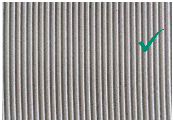
A ragasztóanyag terítésének megfelelő technikája
