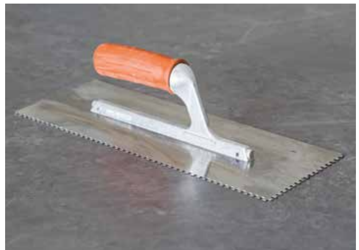
Aljzatra történő terítéshez használt lekerekített fogú simító, illetve burkolólapok hátoldalára történő felhordáshoz használt szögletes fogú simító
