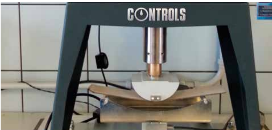
Cementkötésű ragasztóanyag alakváltozásának mérése
