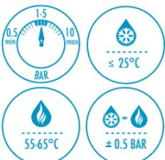
Nu se recomandă folosirea bateriei termostatice împreună cu încălzitoarele de apă instant pe gaz și electrice.
